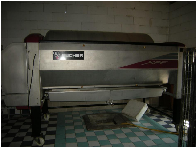
Pressoir à membrane pneumatique, photo : G. Armani
