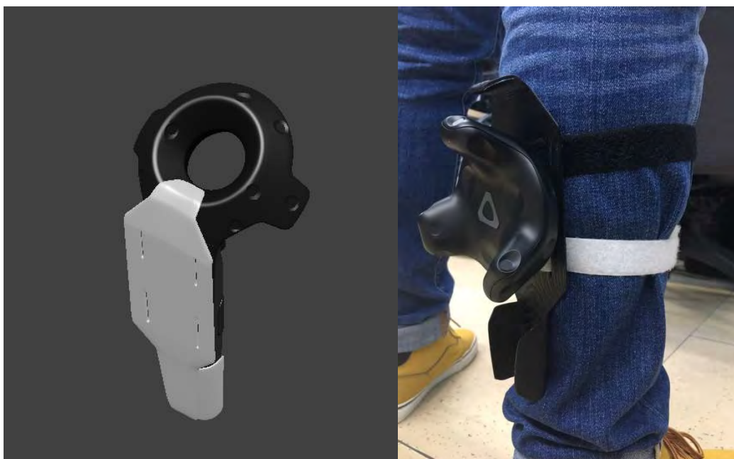
Figura 74. Supporto modellato con l'ausilio di Blender e di una stampante 3D
