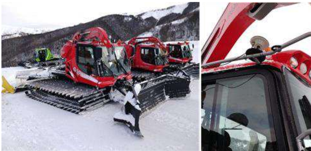
Fig. 14. Il mezzo battipista (a sinistra) e l'installazione dell'antenna sulla parte superiore del veicolo.
