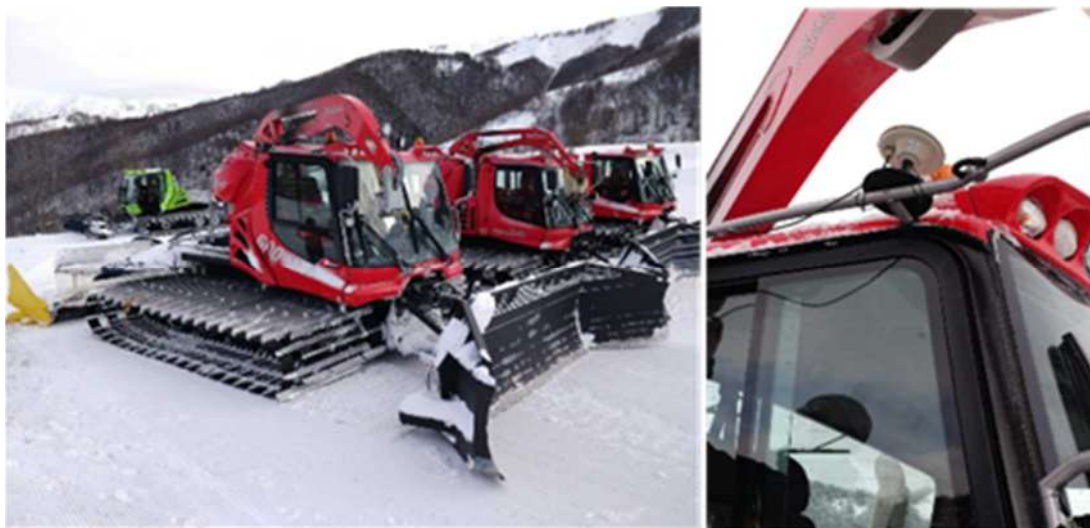
Figure 14. La dameuse (à gauche) et l'installation de l'antenne sur le toit du véhicule.
