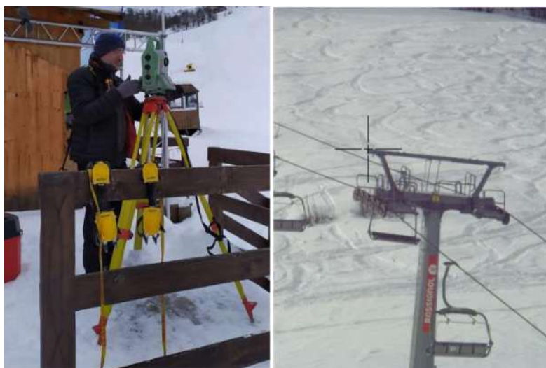
Fig. 12. Rilievo di dettaglio con la stazione totale.
