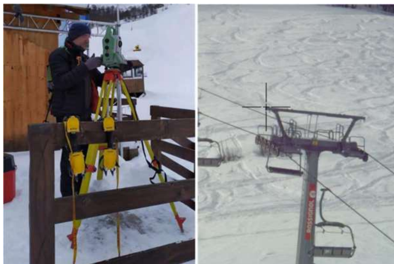
Figure 12. Levé de détail avec la station totale.
