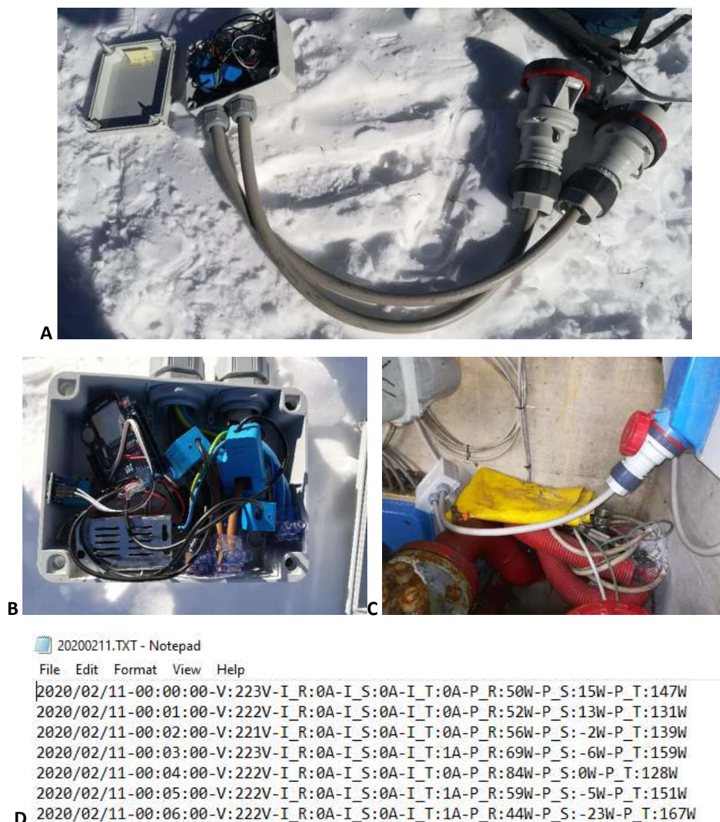
Fig. 17. Datalogger di potenza elettrica trifase penta polare: strumento con spina e presa (A), particolare della scatola con le 3 pinze amperometriche e la scheda Arduino con SD card (B), collegamento ad alimentazione (C) e schermata della potenza misurata sulle tre fasi (P_R, P_S e P_T) (D).
