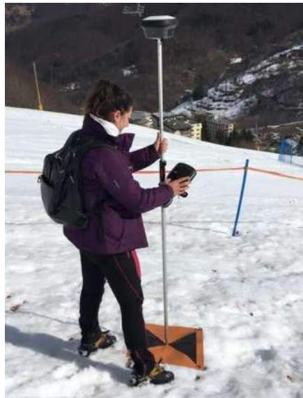
Fig. 11. Misurazione dei GCP con approccio RTK.
