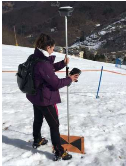
Figure 11. Mesure du GCP avec l'approche RTK.
