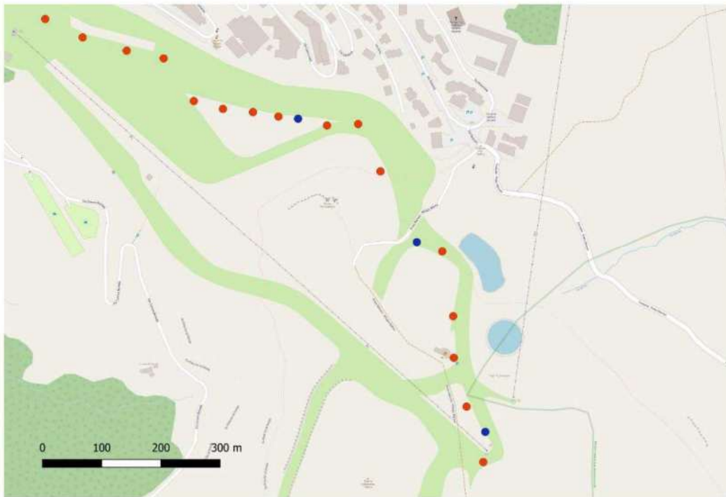
Fig. 3. Lances et canons pour l'enneigement de la piste Prel.
