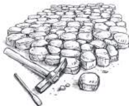
La calade en pierres sèches limite l'érosion en permettant à l'eau de s'évacuer par les joints.
