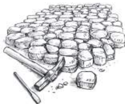
Il selciato in pietra a secco limita l'erosione permettendo all'acqua di drenare attraverso i giunti.
