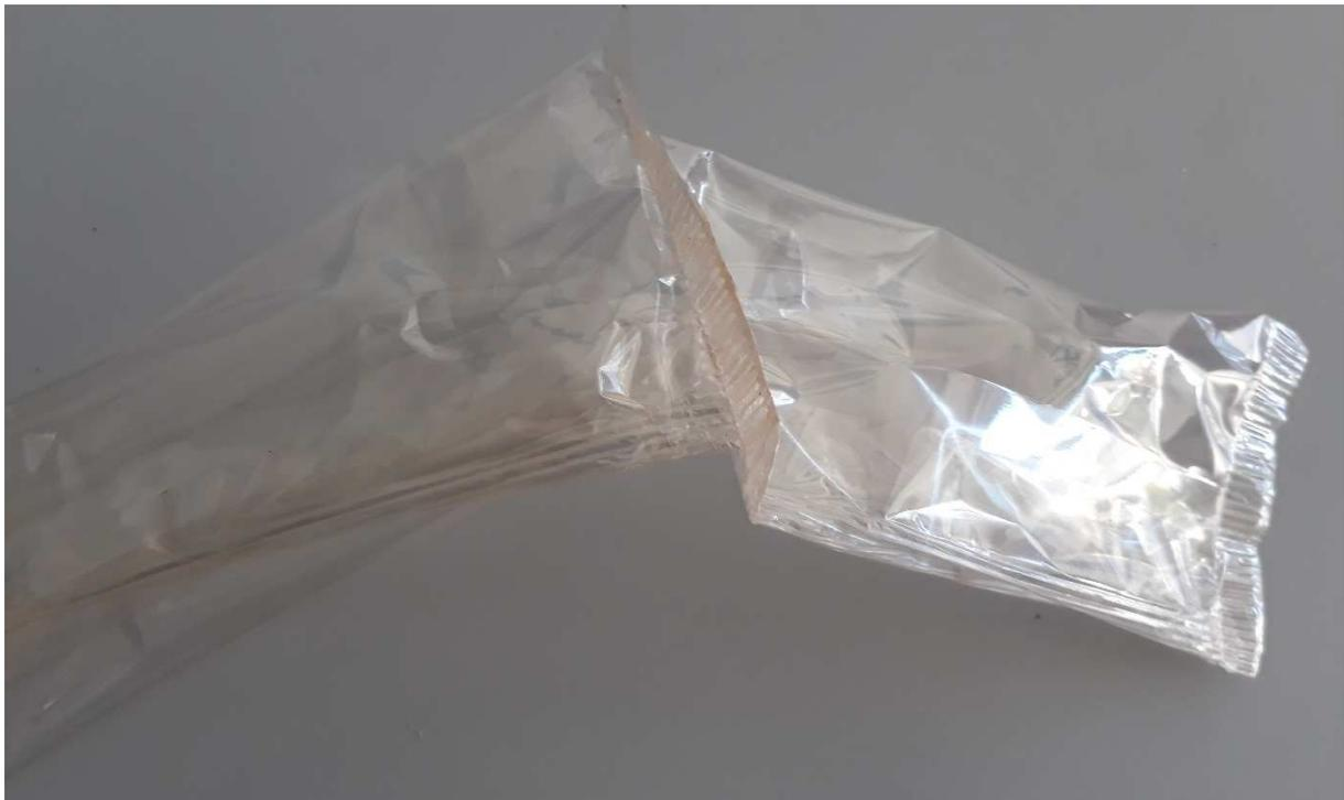
Figura 12. Confezioni difettose in materiale biodegradabile, con evidenti segni di inscurimento in corrispondenza delle saldature
