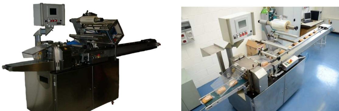
**Figura 9: Macchina confezionatrice orizzontale di tipo flow-pack disponibile presso i laboratori di MIAC – Polo AGRIFOOD**
