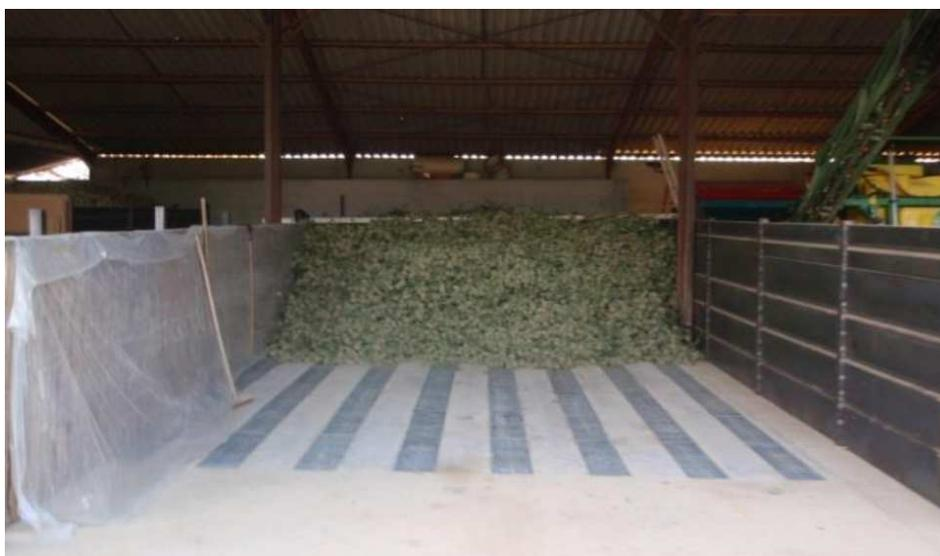
**Figura 13** : Esempio di un essiccatore a canali<sup>16</sup>
