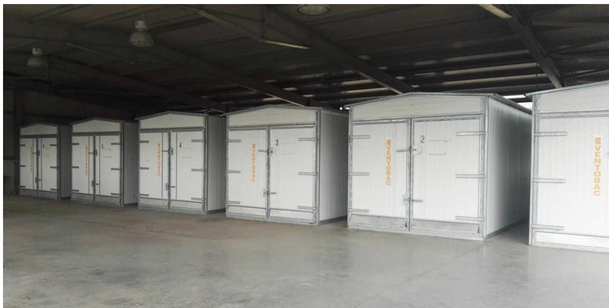
**Figura 10** : Essiccatoi per tabacco ricondizionati per l'essiccazione di piante aromatiche in Grecia. Sportelli di apertura metallici visibili nella parte inferiore degli essiccatoi.<sup>12</sup>
