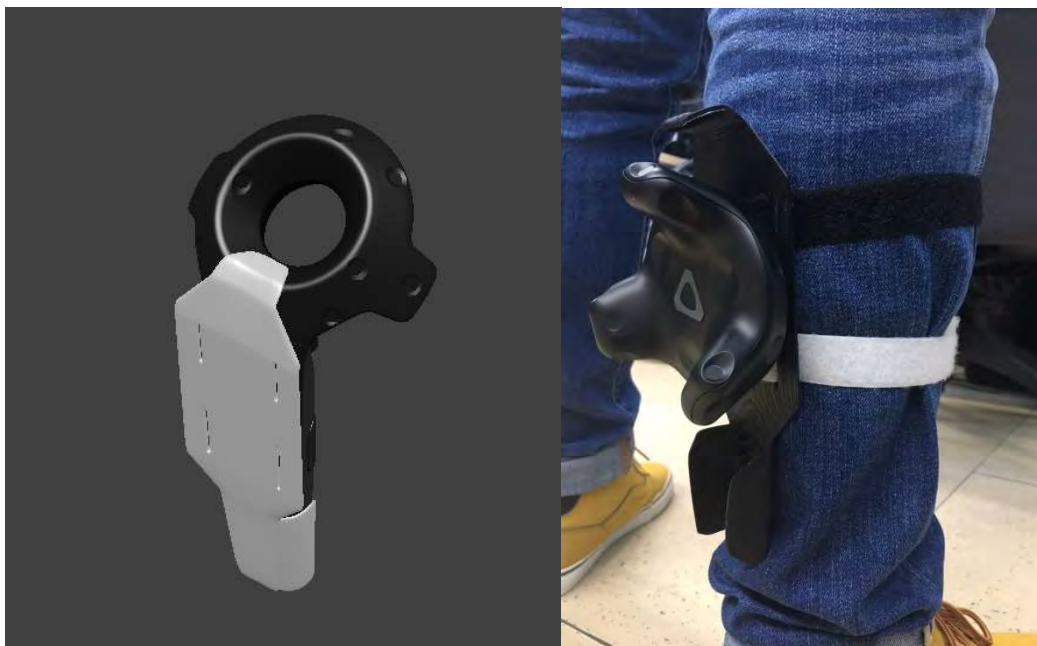
Figure 74: Support modelé avec l'aide de Blender et d'une imprimante 3D
