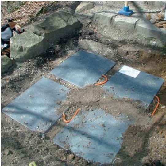
Compteur à pression et capteurs à induction électromagnétique (www.eco-compteur.com)
