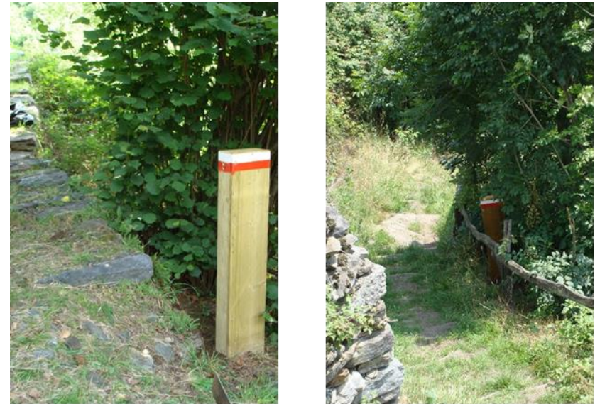
Compteurs pyroélectriques situés le long des points de passage obligatoires (Regione Piemonte)
