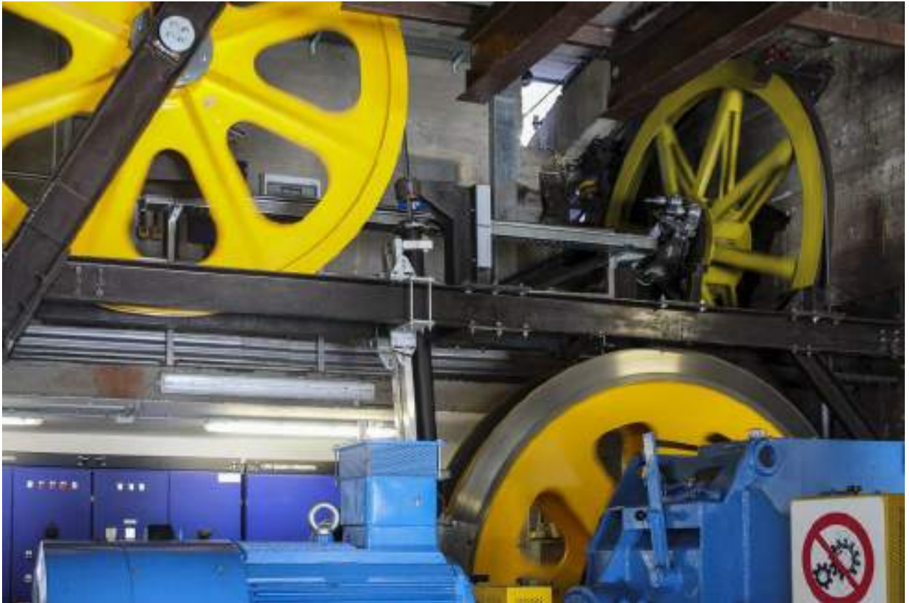
Les engrenages du téléphérique et les différents moteurs. Courmayeur, Italie 03.2019
