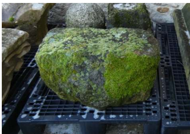
31 - 32: Un capitello romanico al momento dell'applicazione del biocida e dopo il periodo di necrotizzazione
