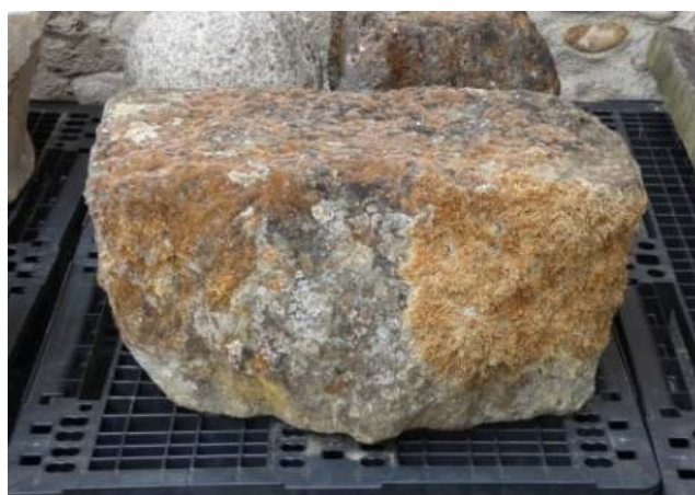
31 - 32: Un capitello romanico al momento dell'applicazione del biocida e dopo il periodo di necrotizzazione
