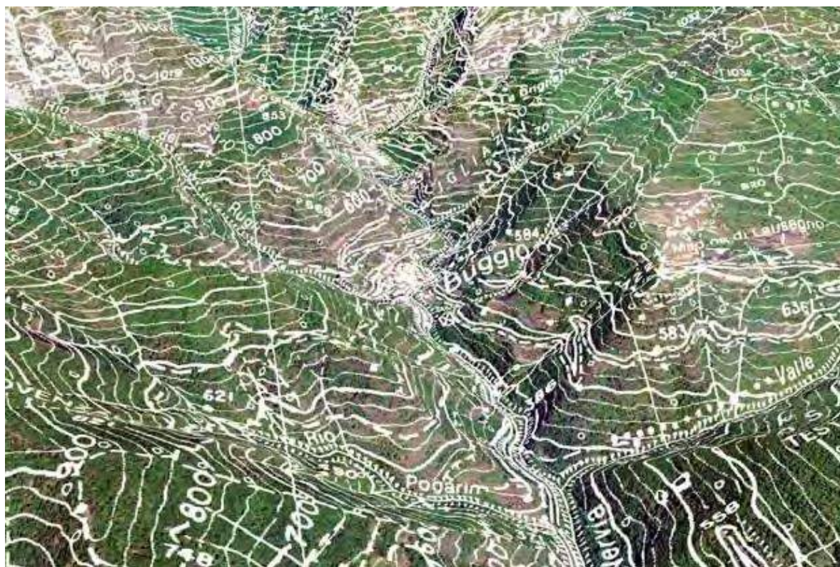
Fig. 2- Une image traitée du programme online Google Earth montre la superposition du traitement cartographique de la CTR de la Regione Liguria à l'échelle 1 :25.000 avec l'image satellite proposée par le programme.
